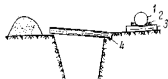
Рис. 59. Ремонт газопровода на бровке траншеи.
