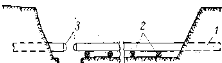
Рис. 58. Ремонт газопровода в траншее на лежках.
